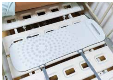
ベッドのマットレスの下に眠りSCANの本体がセットされています。利用者の体にはいっさい接触せず、呼吸や心拍を計測します。
