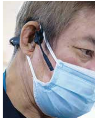
スタッフが耳に装着しているインカム。骨伝導タイプでクリアに聞こえ、両手がフリーになるので作業の邪魔になりません。
