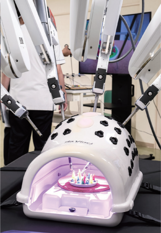
ダビンチ専用のシミュレーション用機器を使ったデモンストラーション。ペイシエントカートの動きがさらによくわかります。
