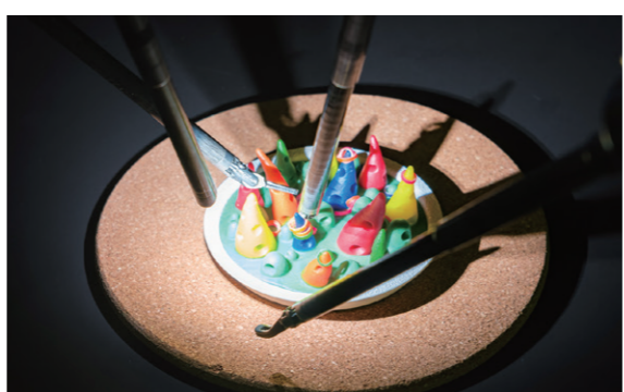
ゴム製のリングを突起から突起へ移すデモンストレーションを行っています。ダビンチの手は人間の手よりも繊細かつ正確に動き、手ブレもしません。このリングを動かす操作は初めて腹腔鏡を触った人ではまずできません。
