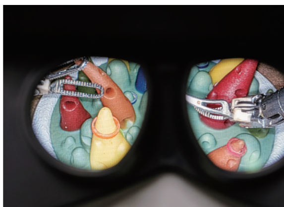
執刀医はサージョンコンソールに向かい、内部に映し出される3D映像を見ながら手で操作します。その動きをペイシエントカートのアームに伝える仕組みです。
