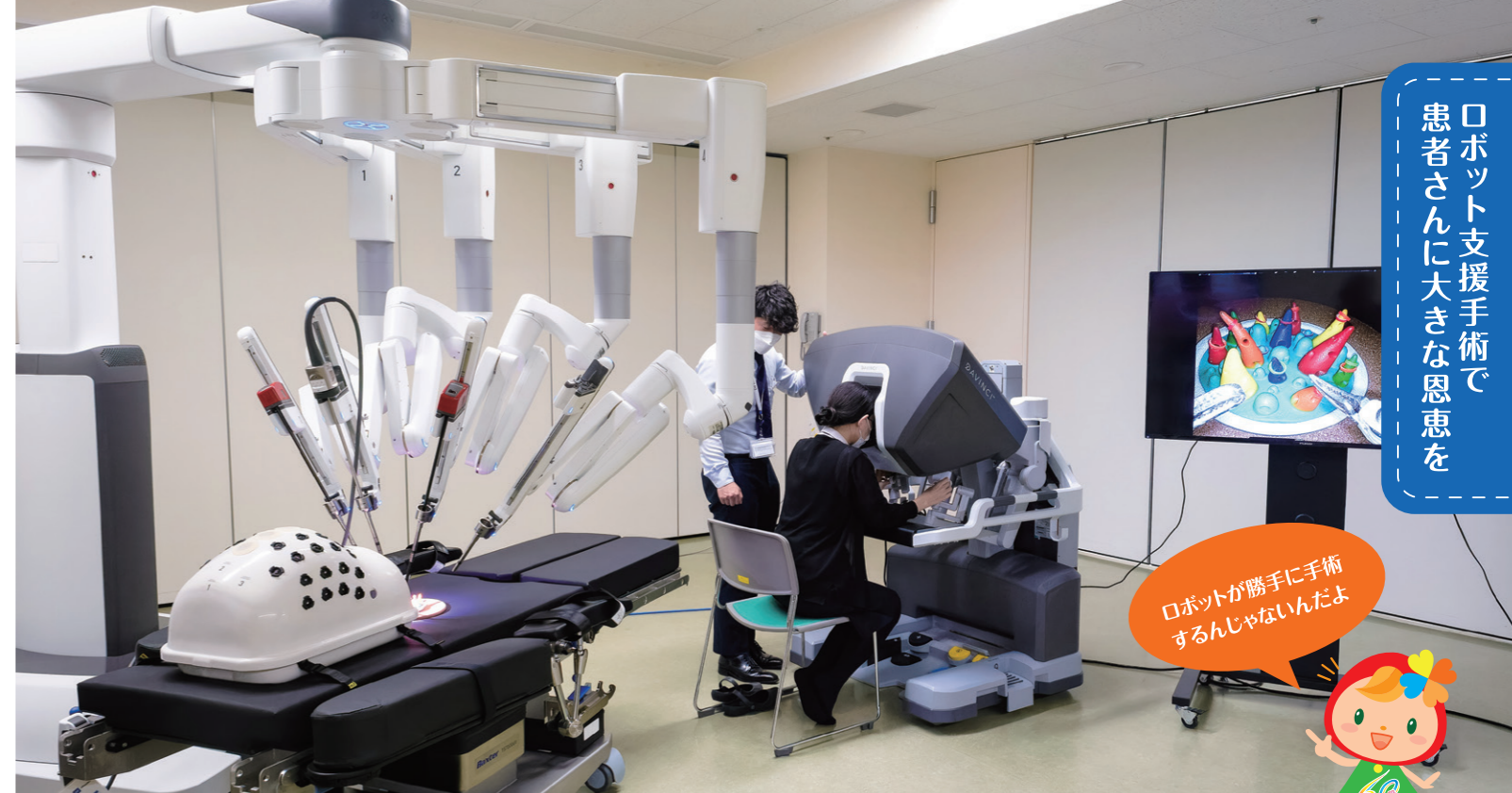
この写真ではダビンチの全体像が見られます。手前左にロボットが実際に手術を行う患者カートと手術台、その右に執刀医が座って手を動かすサージョンコンソールがあります。
